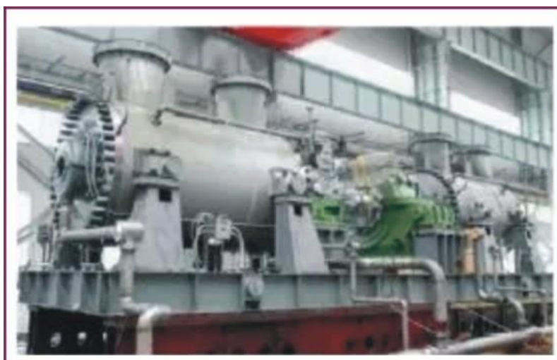
图17 驱动器双输出轴的双缸筒形压缩机组
