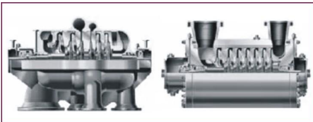
图3 单轴离心压缩机（左：水平剖分型；右：垂直剖分型）
